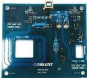
[DF2001A, компенсационный модуль для устранения временного сдвига между пробниками,](#)
