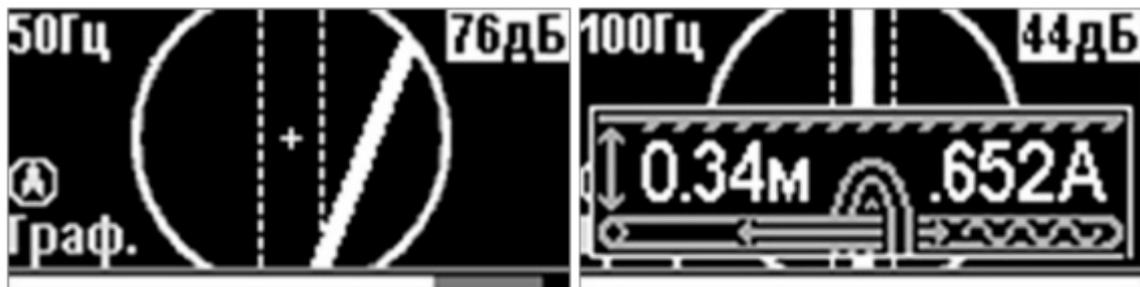
**Режим «График».** На индикаторе дополнительно с положением трассы отображается график изменения уровня сигнала на рабочей частоте. Режим «График» удобен при слабом уровне сигнала или в случае, когда электромагнитное поле искажено.
