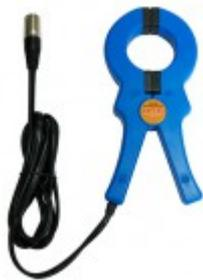
[КИ-105/50, клещи индукционные, диаметр 50мм](#)
