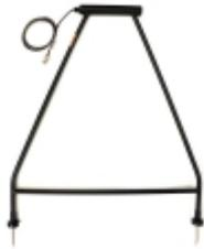
[ДКИ-137, датчик контроля качества изоляции](#)
