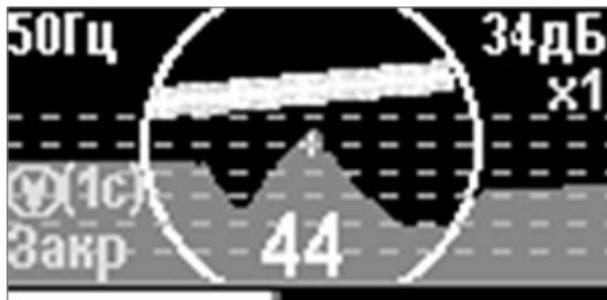
**Режим «График+».** Режим позволяет находить пересекающие трассируемую коммуникацию силовые кабельные линии над напряжением.
