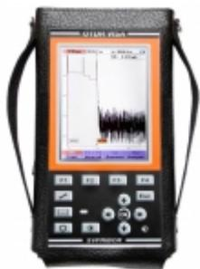
[OTDR VISA 1310/1490/1550 M2, оптический рефлектометр](#)
