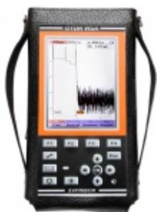
[VISA 1550 M2, оптический рефлектометр](#)
