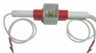
Испытательная ячейка ГОСТ 6581-75, для определения пробивного напряжения трансформаторных масел
