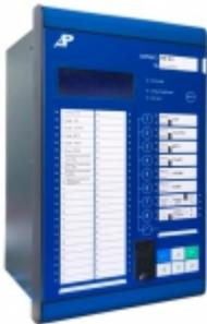
[Сириус-УВ-02-0-0-А5Т-К404-41, устройство микропроцессорной защиты и автоматики](#)
