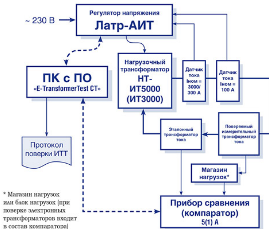
Рис.1. Типовая схема применения МАРС-АИТ в составе поверочной установки в режиме поверки ИТТ
