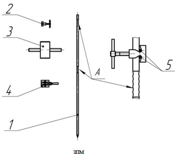
Рис. 1. Комплект заземлителя ЗПМ и схема крепления проводов заземления.
