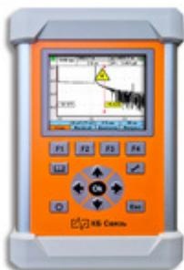
[Квант-4M0, рефлектометр оптический \(динамический диапазон 38/36дБ\) + VFL + Ethernet-тестер + измеритель мощности оптического сигнала](#)
